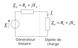
On considère un générateur linéaire représenté par son modèle de Thévenin (par exemple , la sortie d'un amplificateur de puissance).
